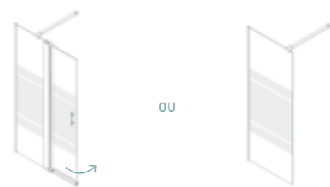
Paroi fixe (800 ou 900 livrée avec barre Arsis 500 mm) + volet pivotant
